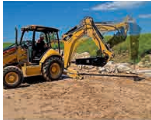
A Caterpillar a kotrórakodókhoz és kisméretű kotrókhoz kialakított H75E és H95E (képünkön) bontókalapácsokkal bővítette E-sorozatú termékcsaládját
