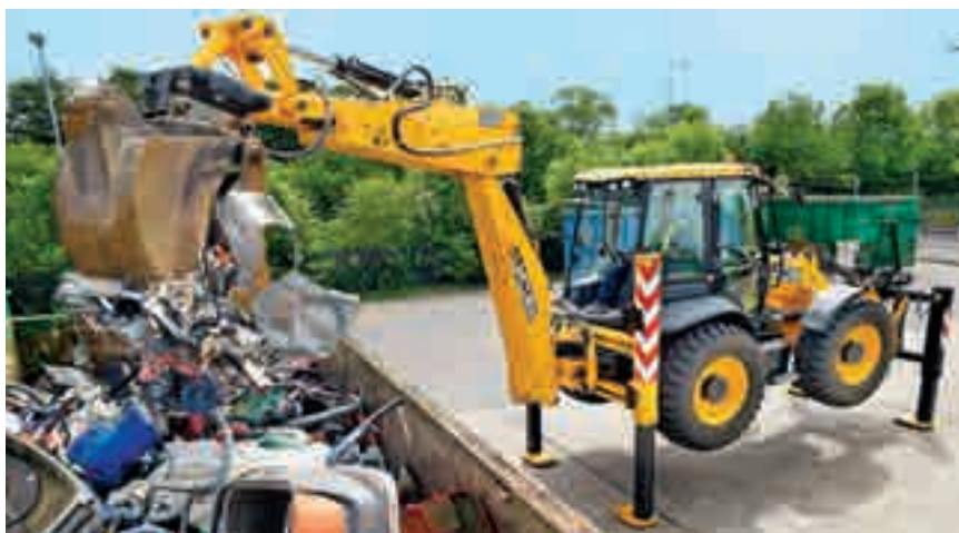
Munkában a hulladékgazdálkodási felhasználásra átalakított JCB 4CX Wastemaster
